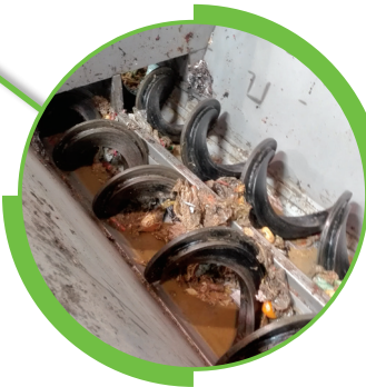
Les trémies OPAL permettent de confiner tous les produits, y compris les produits semi-liquides
